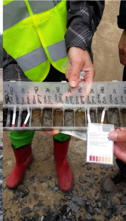
Vasen kuva: Työturvallisuus huomioitiin mm. asemoimalla näyteputket hiekkaiseen maahan ja lisäämällä vetyperoksidia pieninä annoksina. Oikea kuva: Inkuboitujen maanäytteiden happamuuden vertailua pH-indikaattoriliuskojen avulla.
