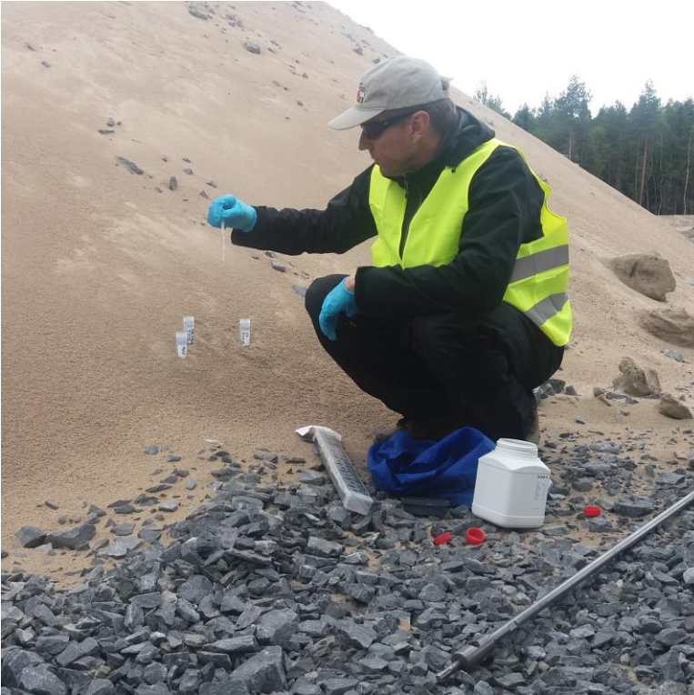
Vasen kuva: Työturvallisuus huomioitiin mm. asemoimalla näyteputket hiekkaiseen maahan ja lisäämällä vetyperoksidia pieninä annoksina. Oikea kuva: Inkuboitujen maanäytteiden happamuuden vertailua pH-indikaattoriliuskojen avulla.
